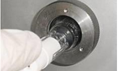
Vyjměte UV lampa společně s teflonovými aretacemi (pokud jsou) a položte je na čistý a měkký povrch.
