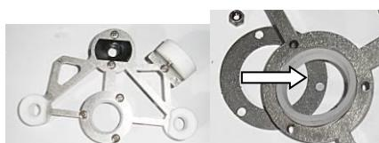
Vyjměte celý blok těsnění ze spodní části.
