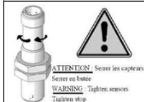
Je důležité věnovat pozornost míře dotažení automatického dorazu stíracího systému, stejně jako správnému zapojení koncovky na odpovídající senzor ("SHORT" nebo "LONG"). Zkontrolujte opatrně míru dotažení.
