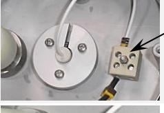
Uvolněte kabely na svorkovnici na obou stranách UV lampy odšroubováním elektrického zapojení (pouze bílý kabel napájející UV lampu).
