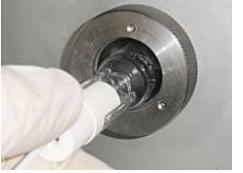
Vyjměte UV lampa společně s teflonovými aretacemi (pokud jsou) a položte je na čistý a měkký povrch.
