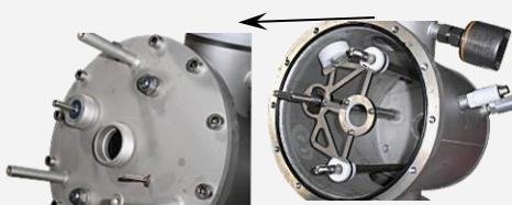
Vyjměte horní část UV jednotky z vodících lišt (šipky).
