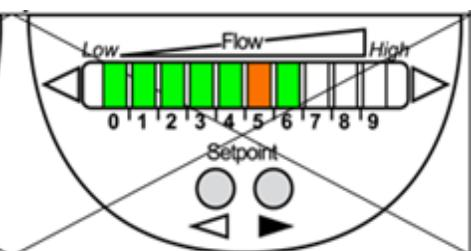
Nyní je senzor zkalibrován a systém plně provozuschopný. Opětovně nastavte průtok přes reaktor na maximální hodnotu (provozní výkon) a uzavřete obtok, By-pass.
