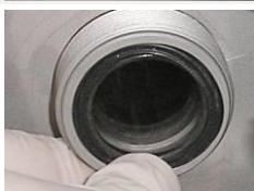
**Výměna křemíkového těsnění:**
