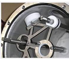
Nasadte blok těsnění na spodní část (čistící válec).
