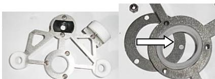
Vyjměte celý blok těsnění ze spodní části.
