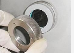
Odšroubujte MP matice na obou stranách a odstraňte hliníkovou podložku.
