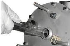
Vložte křemíkové pouzdro/krycí sklo zpět ve směru označeném na štítku UV jednotky a udržujte ho v ose.
