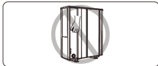
1.4.3. Neumísťujte překážky před vstup a výstup vzduchu tepelného čerpadla.
