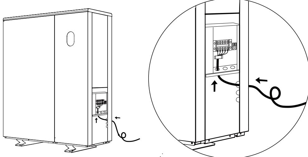
④ Nainstalujte vnitřní kryt a pravý dolní panel
