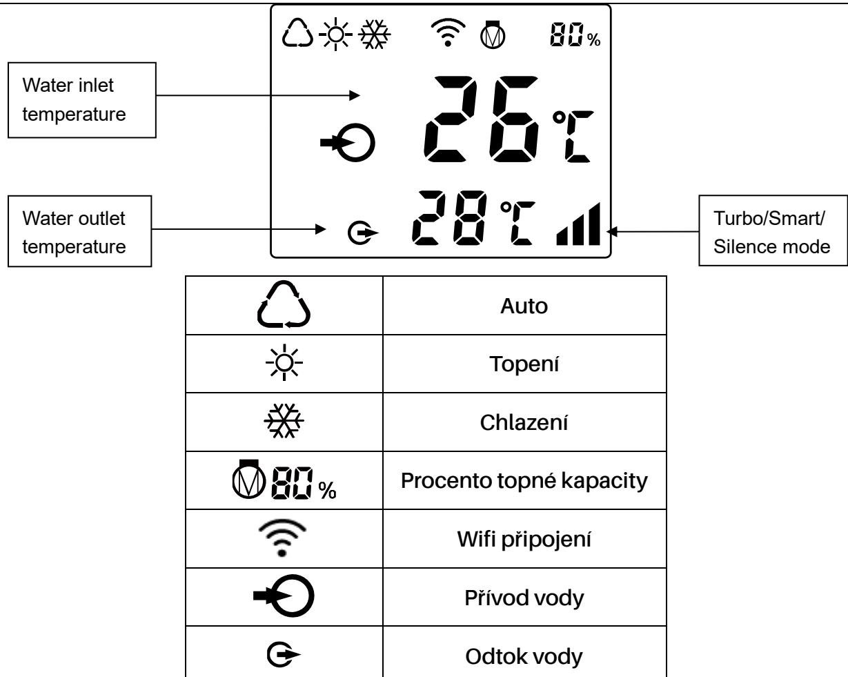
1. Zapnutí: Zmáčkněte na 3 vteřiny k rozsvícení obrazovky, potom zmáčkněte k zapnutí samotného tepelného čerpadla.
