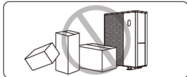
1.4.4. Nestrkejte nic do vstupu nebo výstupu, neboť to může vést ke snížení účinnosti tepelného čerpadla nebo jeho zastavení.
