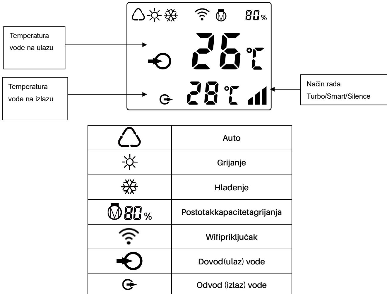
1. **Uključivanje:** za osvjetljavanje zaslona oznaku držite pritisnutu 3 sekunde, nakon toga za uključivanje toplinske crpke pritisnite oznaku .
