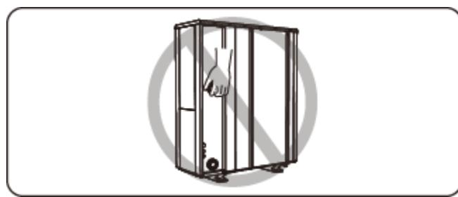
1.4.3. Ne odlažite predmete ispred otvora toplinske pumpe za ulaz i izlaz zraka.
